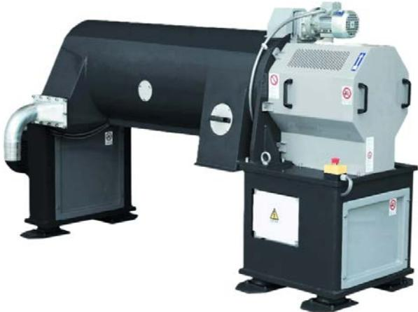
**Центрифуги** используют в различных отраслях промышленности для разделения неоднородных систем. Принцип основан на воздействии центробежной силы на неоднородную систему, состоящую из двух или более фаз - суспензию (жидкость-твердое вещество), эмульсию (жидкость-жидкость), аэрозоли (газ-твердое вещество или газ-жидкость).
