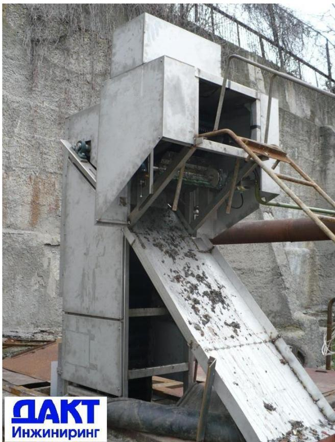
горизонтальную, то есть двойную фильтрацию. Непрерывное самоочищение поверхности достигается конструкцией элементов фильтра и их взаимодействующими взаимоблокировками.
