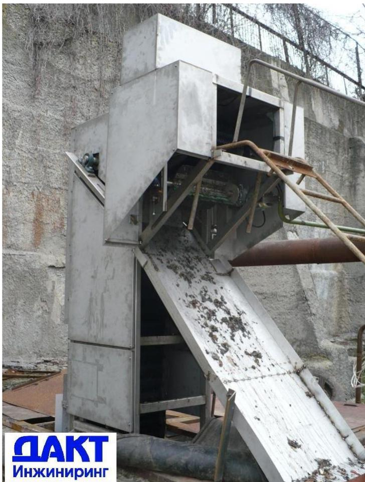
нержавеющая сталь DIN 1.4031 или 1.4401). Надежная рама – свободно-несущая, может в зависимости от типа закрепляться на дне или на верхней кромке канала.
